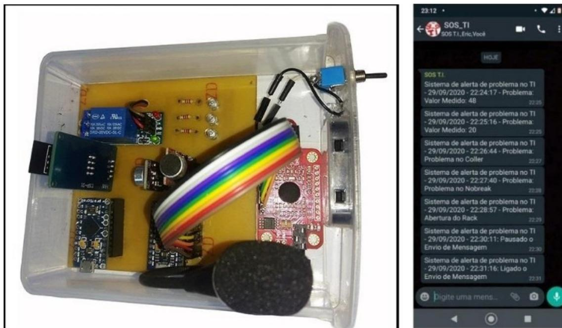
**Figura 6.** Protótipo integrado operacional com a (a) placa de circuito com os componentes e (b) exemplo de execução das notificações por mensagens instantânea
