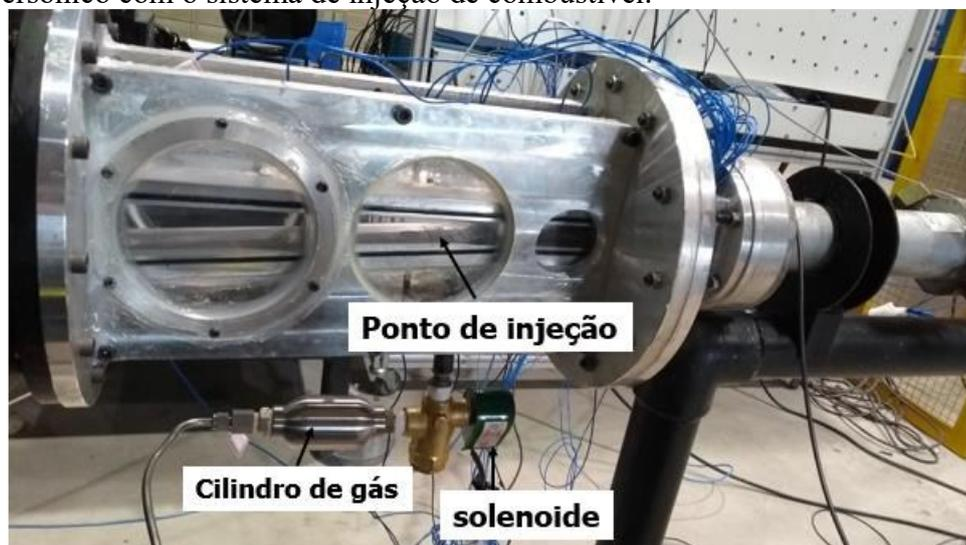
Figura 9. Sistema de injeção de gás acoplado a câmara de combustão supersônica.
