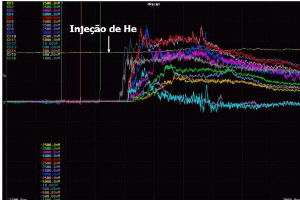
**Figura 10.** Comprovação da injeção de He durante o tempo de teste do experimento, sendo injetada uma pressão de  $P_i = 350$  kPa (3.5 bar).
