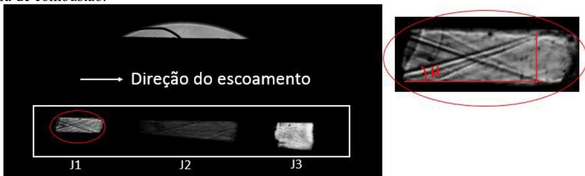
**Figura 8.** Imagem *schlieren* obtida durante os experimentos na câmara de combustão supersônica, utilizada para determinação do número de Mach na entrada da câmara de combustão.
