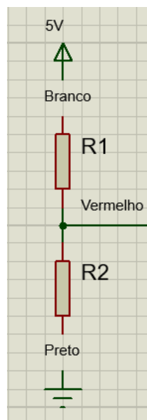
Figura 4. Esquema Elétrico de uma Célula de Carga
