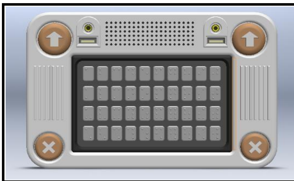
Figura 1: (Modelo do Dispositivo Alfabetizador Braile - Frontal).
