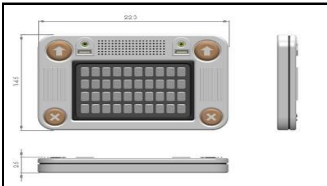
Figura 3: (Modelo do Dispositivo Alfabetizador Braille – Dimensões).
