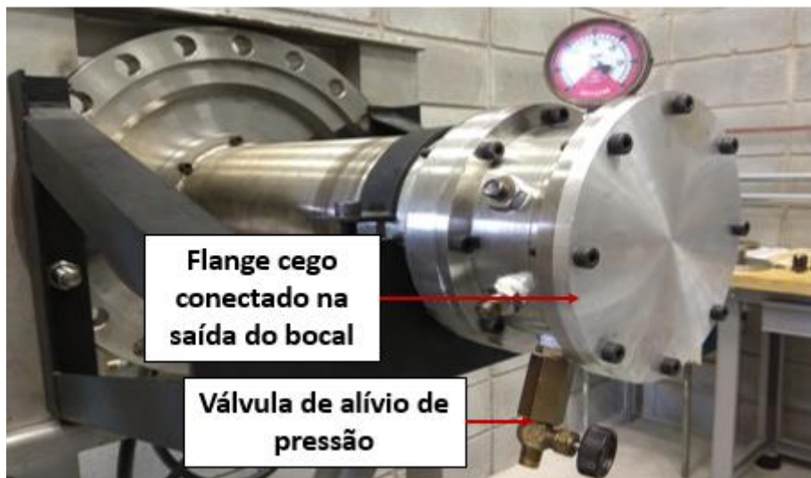
Figura 3. Montagem da BTCS piloto para a realização do teste de estanqueidade.
