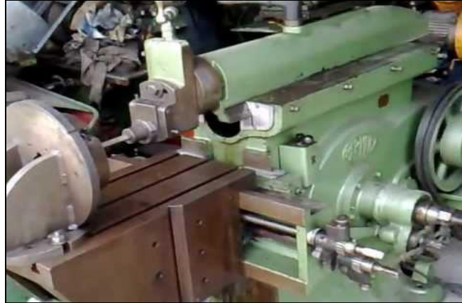
Figura 1. Processo realizado em plaina.
