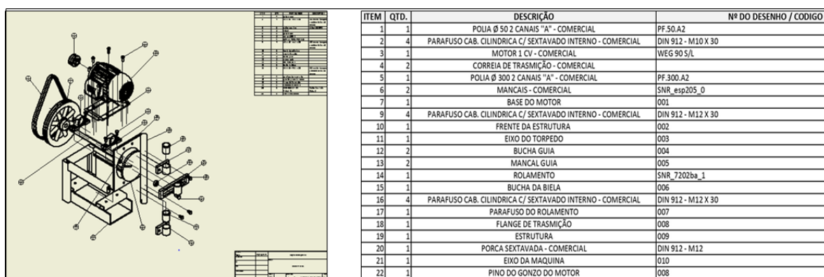
Figura 6. Vista explodida e lista de peças do equipamento
