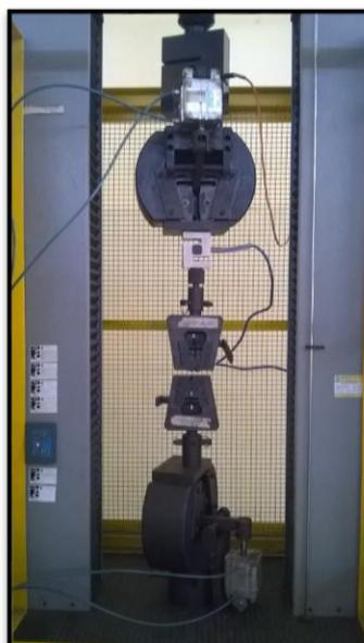
**Figura 3.**Máquina utilizada para realização do ensaio *Lap Shear*.
