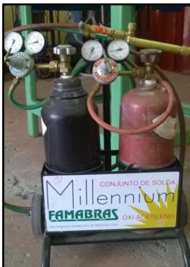
**Figura 1.** Conjunto utilizado para a soldagem oxiacetileno.
