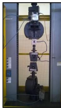
Figura 2. Máquina utilizada na realização do ensaio Lap Shear.
