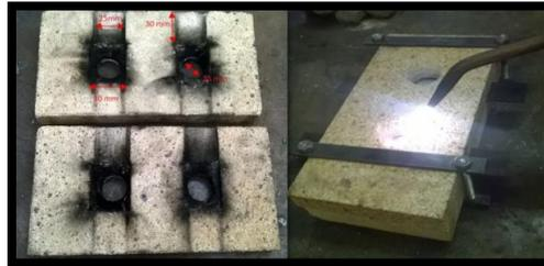
**Figura 1.** Dispositivo utilizado na soldagem com dimensões.
